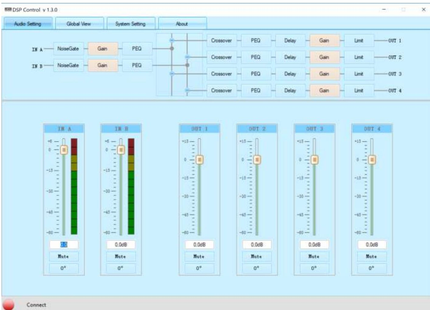
В левом нижнем углу показан находится индикатор подключения программного обеспечения к MDSP-42. Если он горит красным - соединение отсутствует, если зеленым - подключение есть. Физически MDSP-42 должен быть подключен USB кабелем к Вашему компьютеру на котором запущена программа DSP Control. Более подробно процесс подключения описан в разделе УСТАНОВКА ПРОГРАММНОГО ОБЕСПЕЧЕНИЯ DSP CONTROL
